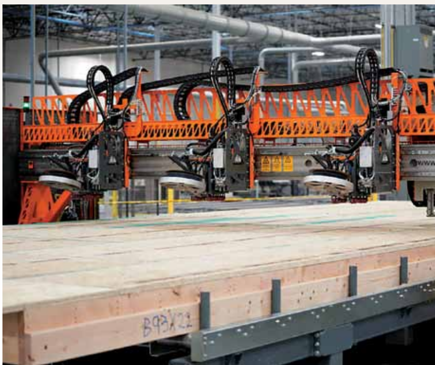
Automatizovana proizvodnja montažnih drvenih panela i krovova u fabrikama
