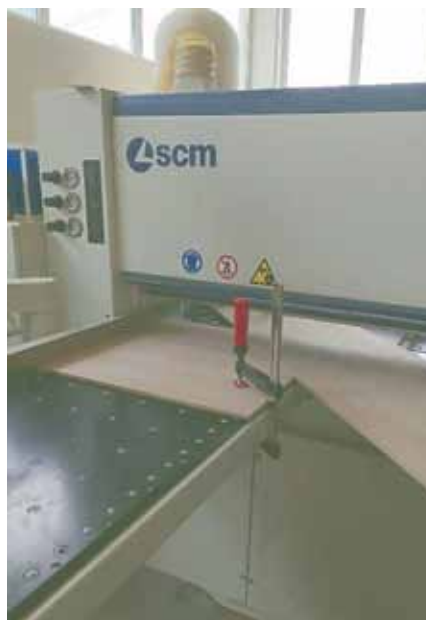
Postupak sečenja modula od furniranih ploča vlaknatica debljine 19 mm, na kojima se uz pomoć CNC mašine profilišu kanali širine 6 mm, na svakih 13 mm razmaka
