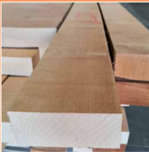
Slika 2. Izgled neobrađene, blago parene bukove daske (levo) i ploče od blago parene bukove frize (desno)
