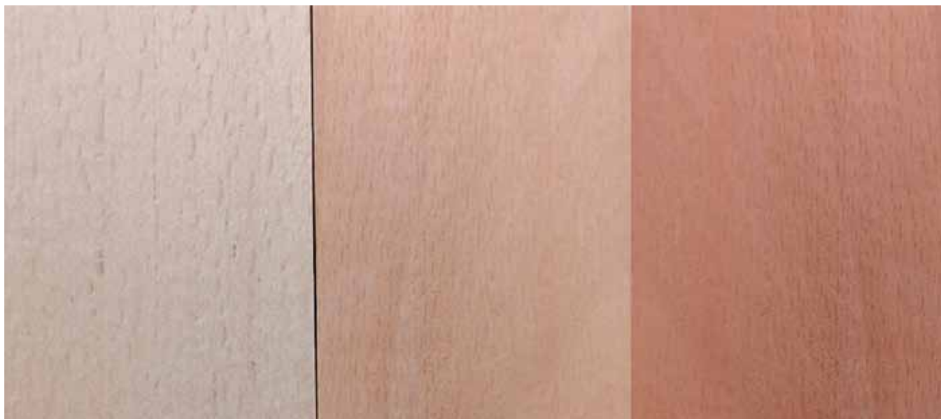
Slika 1. Izgled neparene (levo), blago parene (sredina) i "tvrdo" parene (desno) bukve
