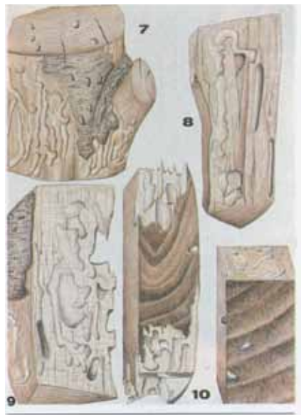
Stromatium fulvum V. - riđa kućna strižibuba 7 - 9 - tipovi oštećenja drveta od larava, 10 - izletni otvori imaga
